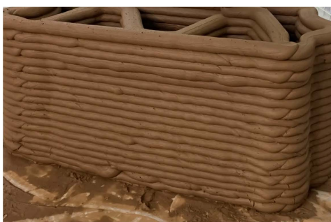
8. ábra - Tiszta, nedves agyagból nyomtatott falrészlet
