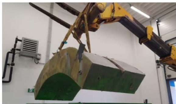
4. ábra - Elkészült betonív
