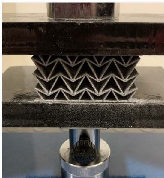
6. ábra. Mintadarab a Kinsgeo KJ-1066 szakítógép nyomólapjai közé téve
