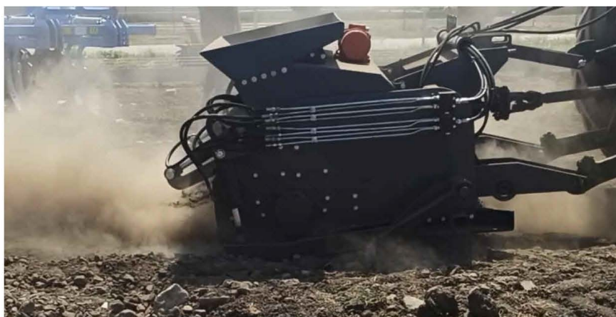
12. ábra. Betondarabokkal teli föld bontási próba
