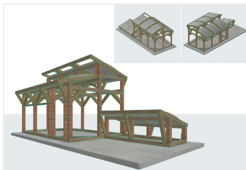
5. ábra - Változtatható ívű öntőformával készült betonelemek tetőként való alkalmazása
