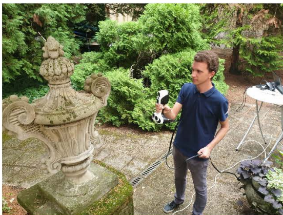
3. ábra. Sérült homlokzati elem szkennelése SCANTECH iReal 2E Color kézi 3D szkennelével
