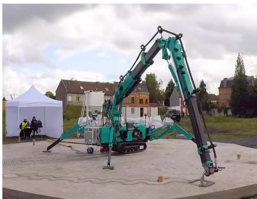
1. ábra - Pókdarura szerelt nyomtató [3]
