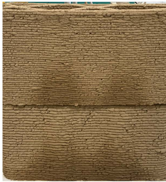
11. ábra - Alul 20 mm, felül 16 mm átmérőjű extruderfejjel nyomtatott rétegek
