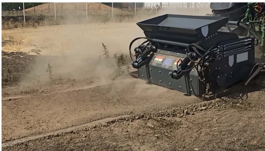
11. ábra. Döngölt föld bontási próba
