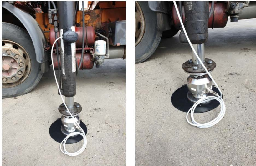
1. ábra. A kitalpaló alá helyezett erőmérő egység
