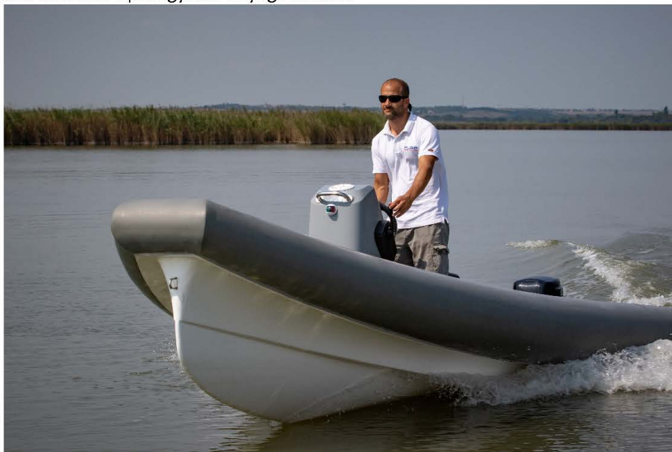
2. ábra: 5.7 m hosszú RIB jellegű hajó hab ütközővel
